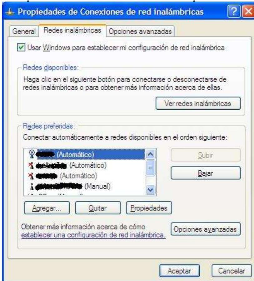
Seleccionem la xarxa que en el llistat de xarxes ens indica que té l'WPA activat, normalment l'SSID ja ens sona ja que l'hem configurat nosaltres, no? Un cop seleccionada apremem "Propiedades" i deixem la pantalla de "Propiedades" tal com segueix:
