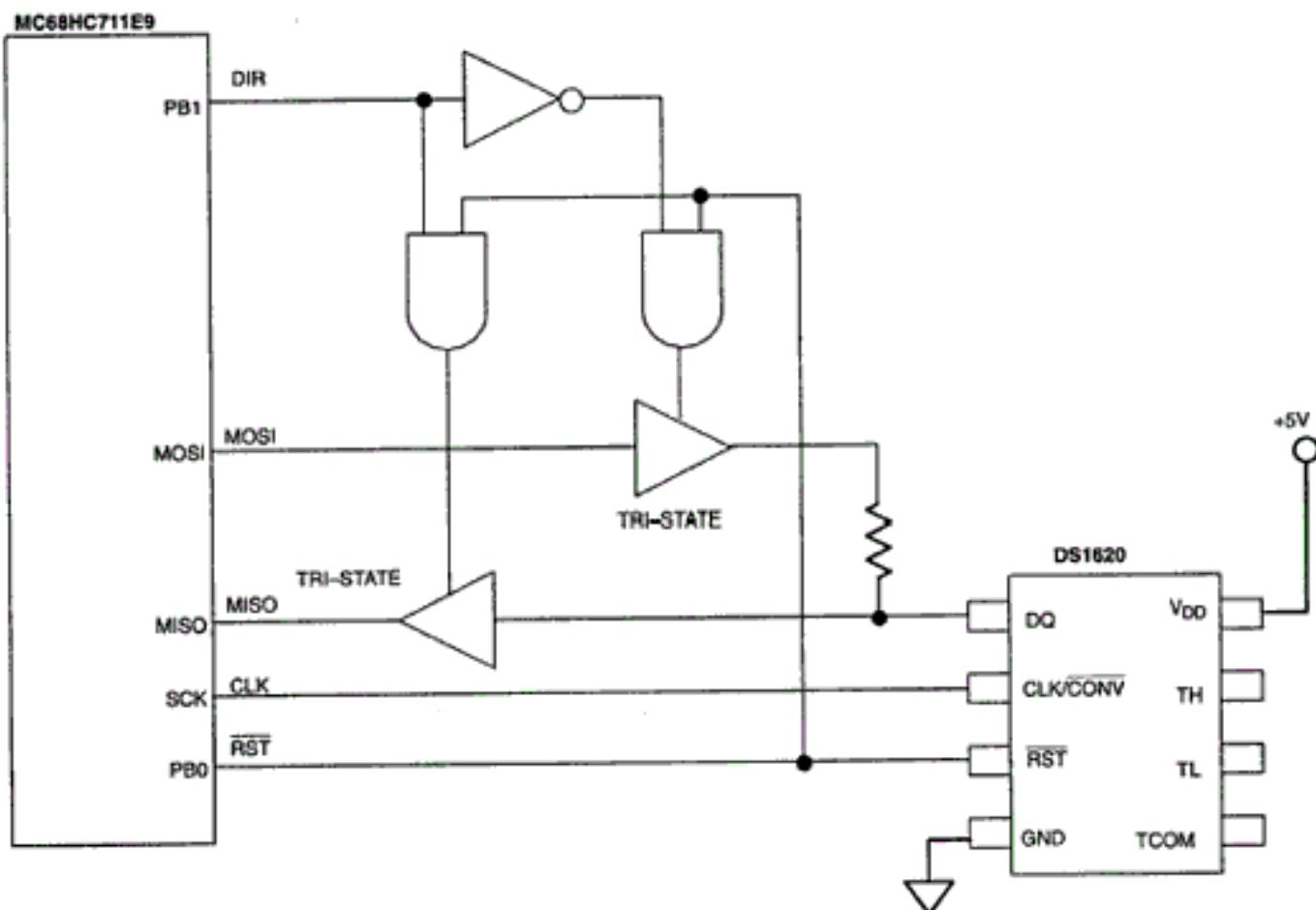
Figure 1. SPI to DS1620 Interface Circuit
